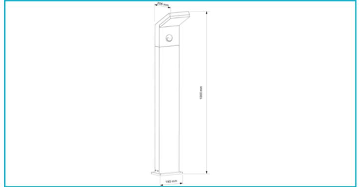
Mit ihrem schlanken, schnörkellosen Gehäusedesign ist die TUCANAE eine moderne Außenleuchte, die sich nahezu überall integrieren lässt. Die 100 cm hohe Pollerleuchte strahlt ihr warmweißes Licht schräg nach unten auf Gehwege und andere Flächen und verfügt in der MOTION Variante über einen integrierten Dämmerungsschalter mit einstellbarer Helligkeitsschwelle und Laufzeit.
