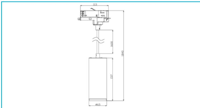
Die passenden DALI Pendelleuchten der LUCEA-Serie für das 3-Phasen 230 V Stromschienensystem ist in 10 W erhältlich und bieten bis zu 1.300 Lumen Lichtleistung. Die maximale Abhängung beträgt 1.600 mm. Über optionale Linsen lassen sich die einzelnen Modelle in ihrem Abstrahlwinkel verengen oder erweitern. Das Gehäuse der Lucea-Leuchten besteht aus Aluminium-Druckguss
