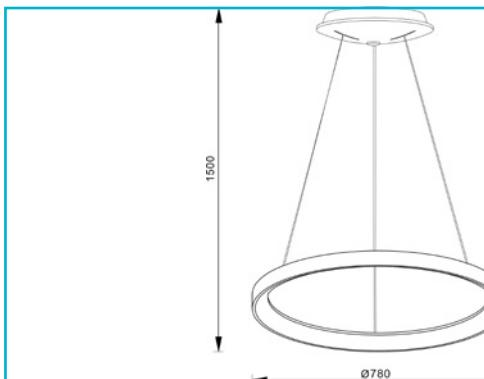
Die Pendelleuchten der neuen MEROPE-Serie vereinen zeitlose Eleganz und reduzierte Modernität. Erhältlich in den Durchmessern 400, 600 und 800 mm, lässt sich die Lichtfarbe [3000/4000K] vor der Installation über einen CCT-Switch auswählen. Die Außenseite setzt auf gebürstetes Aluminium in den Farben Weiß, Silber, Kaffee und Schwarz.
