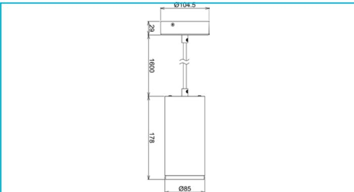
Die Pendelleuchten der LUCEA-Serie mit CCT sind in den Versionen 10, 15, und 20 W erhältlich und bieten bis zu 2000 Lumen Lichtleistung. Die maximale Abhängung beträgt 1800 mm. Über optionale Linsen lassen sich die einzelnen Modelle in ihrem Abstrahlwinkel verengen oder erweitern. Das Gehäuse der LUCEA-Leuchten besteht aus Aluminiumdruckguss.
