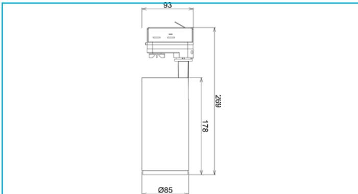
Für das 3-Phasen 230V Stromschiensystem bieten wir Spots der LUCEA-Serie an. In der Version als 3-Phasenspot gibt es sie mit 10, 15, 20, 30 W und ermöglicht damit eine maximale Lichteistung von bis zu 2.900 Lumen. Über optionale Linsen lassen sich die einzelnen Modelle in ihrem Abstrahlwinkel verengen oder erweitern. Für alle Varianten steht zudem eine Torblende als optionales Zubehör zur Verfügung, um die Leuchten auch im gewerblichen und industriellen Umfeld flexibel einsetzen zu können.
