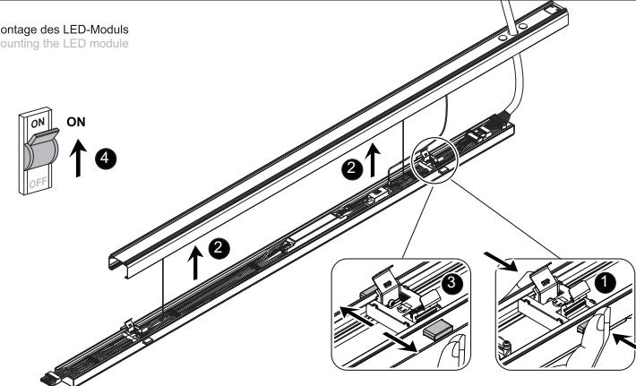
Montage des nächsten LED-Moduls / mounting next LED module
