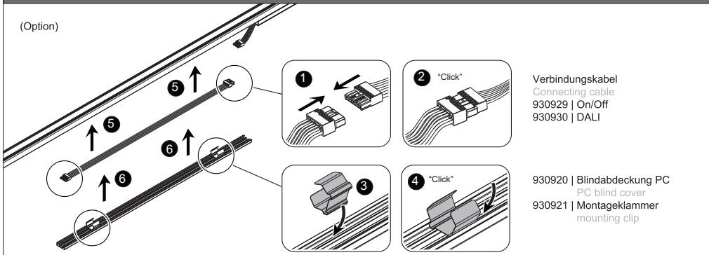
**Schneiden Sie den Blinddeckel auf die gewünschte Länge zu / cut the blind cover to desired length**
