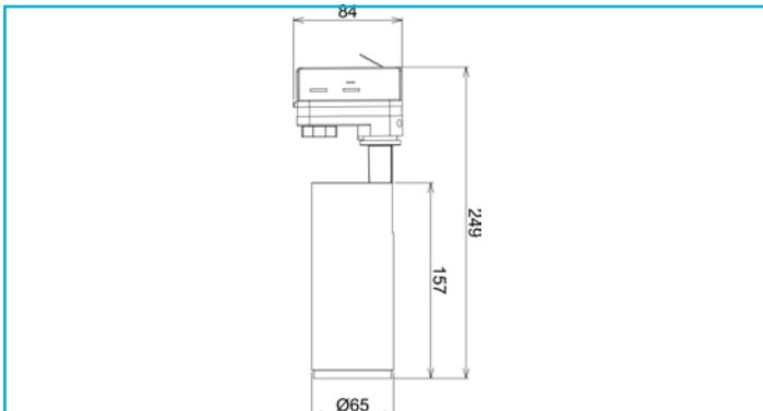
Für das 3-Phasen 230V Stromschiensystem bieten wir Spots der LUCEA-Serie an. In der Version als 3-Phasenspot gibt es sie mit 10, 15, 20, 30 W und ermöglicht damit eine maximale Lichtleistung von bis zu 2.900 Lumen. Über optionale Linsen lassen sich die einzelnen Modelle in ihrem Abstrahlwinkel verengen oder erweitern. Für alle Varianten steht zudem eine Torblende als optionales Zubehör zur Verfügung, um die Leuchten auch im gewerblichen und industriellen Umfeld flexibel einsetzen zu können.
