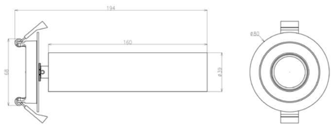
Für unsere SLIM-Leuchtenserie gibt es passende Einbaustrahler. Der Leuchtenkörper aus Aluminium Druckguss ist dabei immer gleich groß [300 x 39mm]. Die SLIM Einbaustrahler haben das gängige Einbaumaß von 68 mm. Damit eignen sich die einflammigen Einbaustrahler besonders gut für Verkaufsflächen, Empfangsbereiche oder auch Hotel und Gastronomie.
