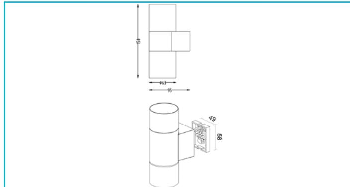
ACHERNAR mit viel Flexibilität: Der GU10-Sockel im schlichten Aluminium-Druckgussgehäuse ermöglicht die freie Wahl des Leuchtmittels für jede Anwendung.
