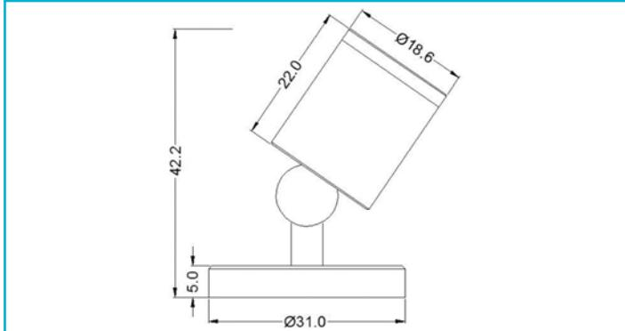
Kleine Helfer, große Wirkung. Mit den HERCULIS Displayleuchten im hochwertigem Aluminiumgehäuse erreichen Sie sämtliche Ecken einer Vitrine. Hierzulässt sich der Leuchtenkopf mit seinem 40° Abstrahlwinkel frei in jede Richtung drehen und schwenken. Zudem ermöglichen die intelligente Kabelführung und das steckfertige System die einfache Auf- und Einbaumontage in Vitrinen, Theken, Verkaufsbereichen oder im Wohnz
