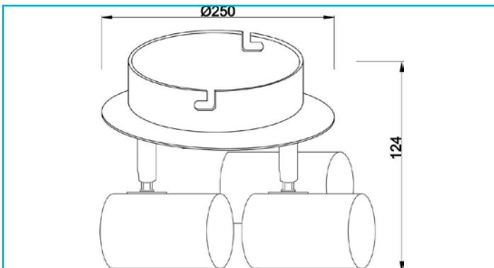
Flexibler Spot - Die Deckenaufbauleuchte Indi verfügt über ein silberfarbenes Aluminiumgehäuse in gebürsteter Optik, in dem sich GU10-Leuchtmittel mit max. 50 Watt befinden. Durch die dreh- und schwenkbaren Elemente lässt sich der Spot flexibel ausrichten und als vielseitige Deckenleuchte verwenden.
