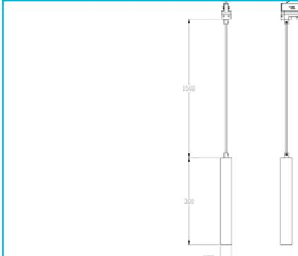
Für das Stromschienensystem gibt es passende Pendelleuchten der SLIM - Serie. Der Leuchtenkörper aus Aluminium Druckguss ist dabei immer gleich groß [300 x 39mm]. Die Pendelleuchten für die Stromschienen ermöglichen eine Abhängung von maximal 180 cm.
