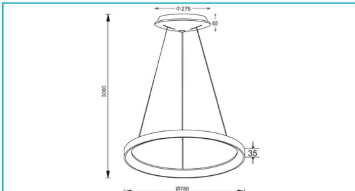
Die Pendelleuchten der MEROPE-Serie vereinen zeitlose Eleganz und reduzierte Modernität. Erhältlich in den Durchmessern 380, 580 und 780 mm, lässt sich die Lichtfarbe [3000/4000K] vor der Installation über einen CCT-Switch auswählen. Die Außenseite setzt auf gebürstetes Aluminium in den Farben Kaffee und Silber bzw. matt gepulvert in Weiß und Schwarz.
