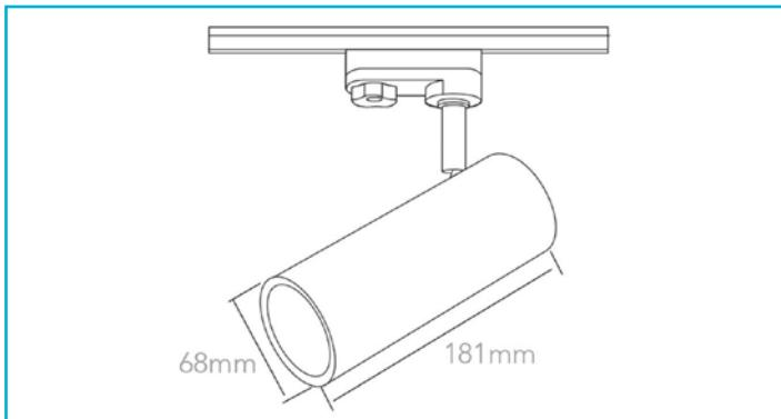
Stromschienen überzeugen in Shops, Showrooms, Büros und mehr mit ihrer konkurrenzlosen Flexibilität. Die Stromschienen-Strahler PLEIONE FOCUS I und II setzen dieser Flexibilität die Krone auf und ermöglichen das stufenlose Einstellen des Abstrahlwinkels im Bereich von 25° bis 60°. Gleichzeitig lässt sich die Linse fokussieren, um Objekte und Flächen präzise und mit hoher Farbtreue in Szene zu setzen.
